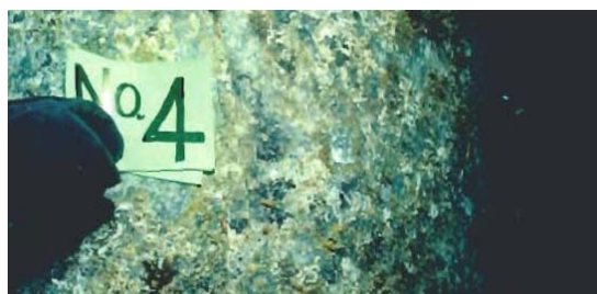
写真-1 電気防食による鋼材表面 への石灰質皮膜の生成状況
