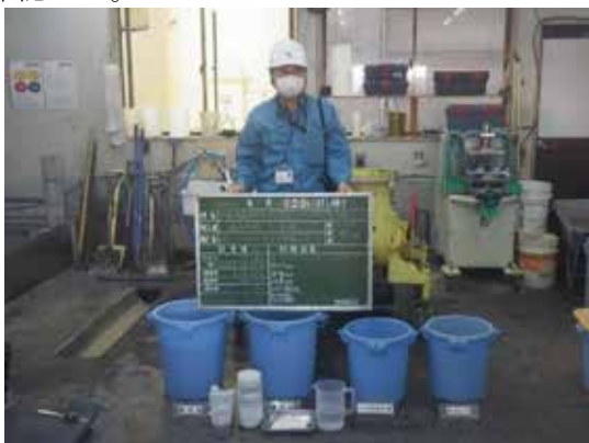
図 27 生コンクリート工場の配合量確認
