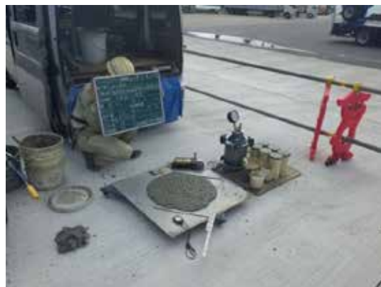
図 31 生コンクリート受入検査
