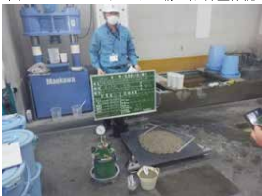
図 28 打設前の監督職員による立会検査
