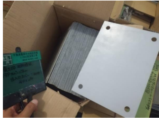
図 24 注入口閉塞パネル
