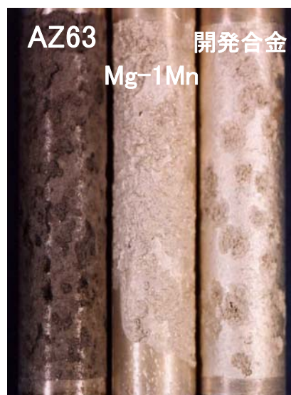
写真 4. バックフィル環境下の溶解形態
