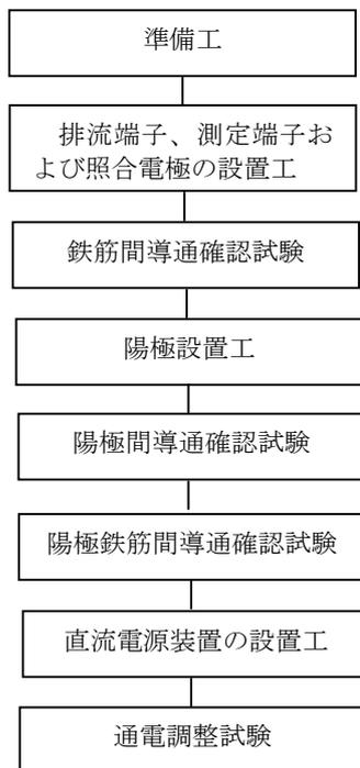
図1 施工工程図
