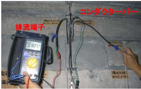
写真3 陽極鉄筋間絶縁確認
