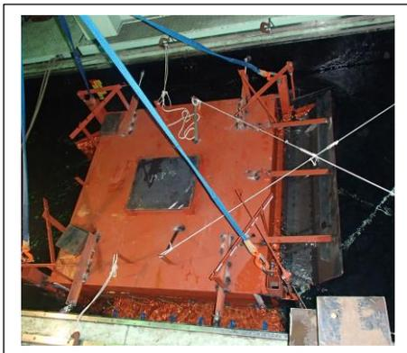
写真1 水流遮蔽装置実証試験用モデル
