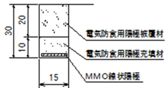
図5 MMO線状陽極部溝断面
