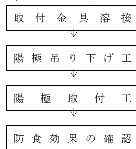
図6 電気防食工 施工手順
