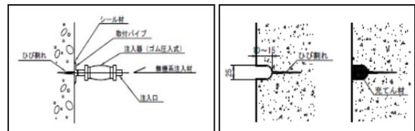
図4 ひび割れ注入工と充填工
