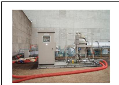
写真5 可搬式槽型鉄イオン供給装置
