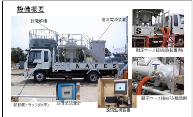
写真12 電解式鉄イオン供給装置の種類
