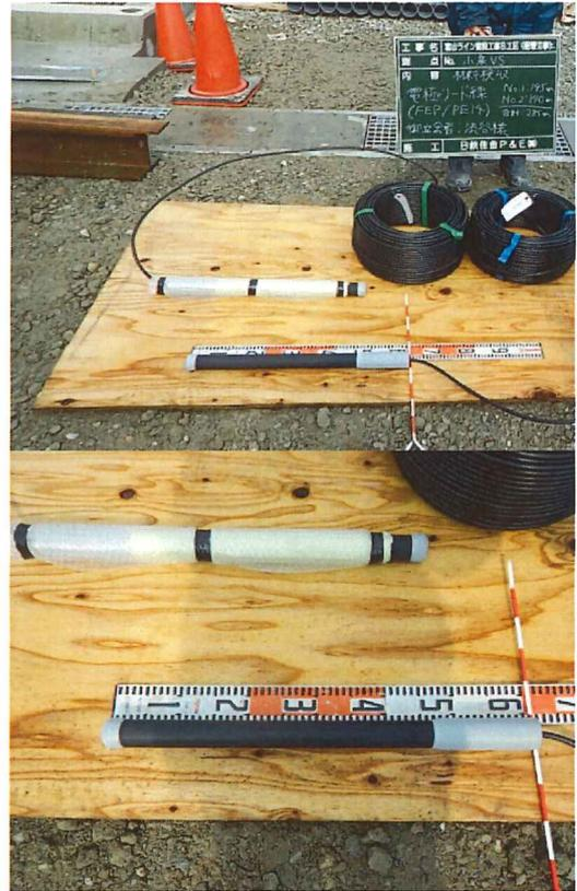
写真2 通電用電極 (NST-5型)
