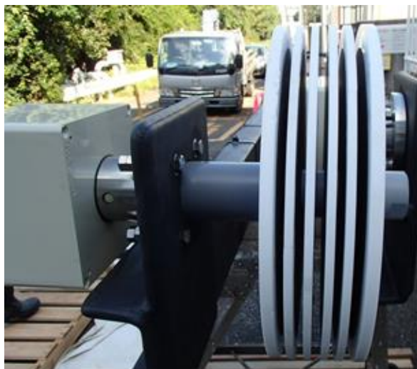
図9 暴露試験用架台と電極
