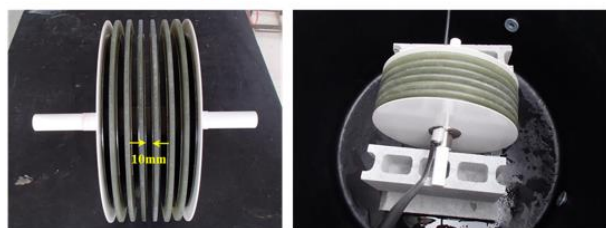
組み立て状況(電極8枚) 設置間隔:10mm
