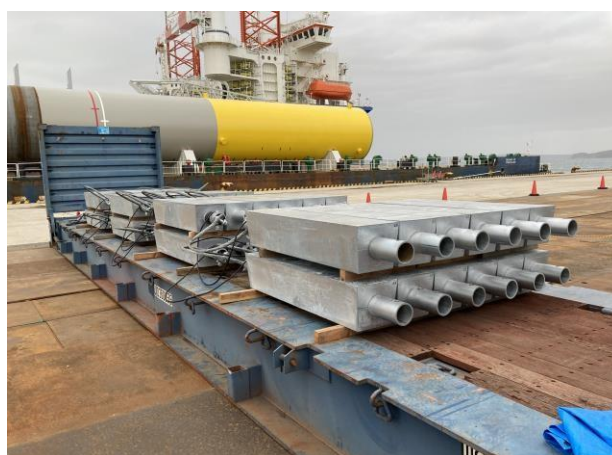
モノパイル内面に取り付けられる亜鉛合金陽極
